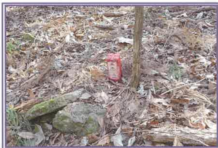
物件14の土地の北西側付近に設置されているものと推察される境界標 (「五五 三一」と記載されている。以下「55 31」と記載する。)
