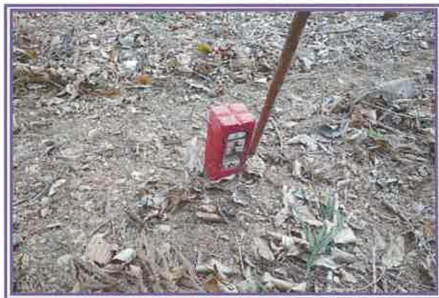
物件16の土地の南西側付近に設置されているものと推察される境界標 （「55 6」と記載されている。）
