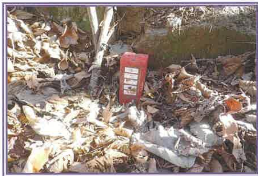
物件18の土地の北西側に設置されているものと推察される境界標 (「32補1」と記載されている。)
