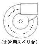
(非常用スベリ台)
