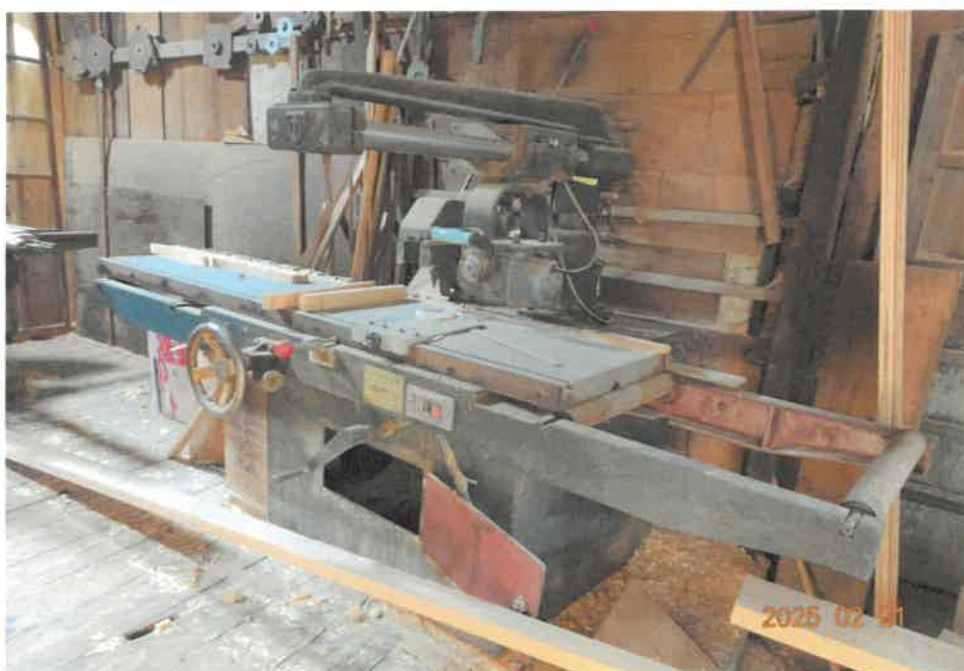
②⑥ (工場機械目録番号17 ほぞ取機)
