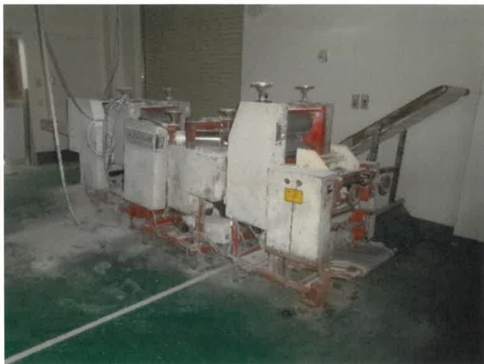
(写真 4 1) 物件 8 の建物内部の機械器具類 (製麺機)
