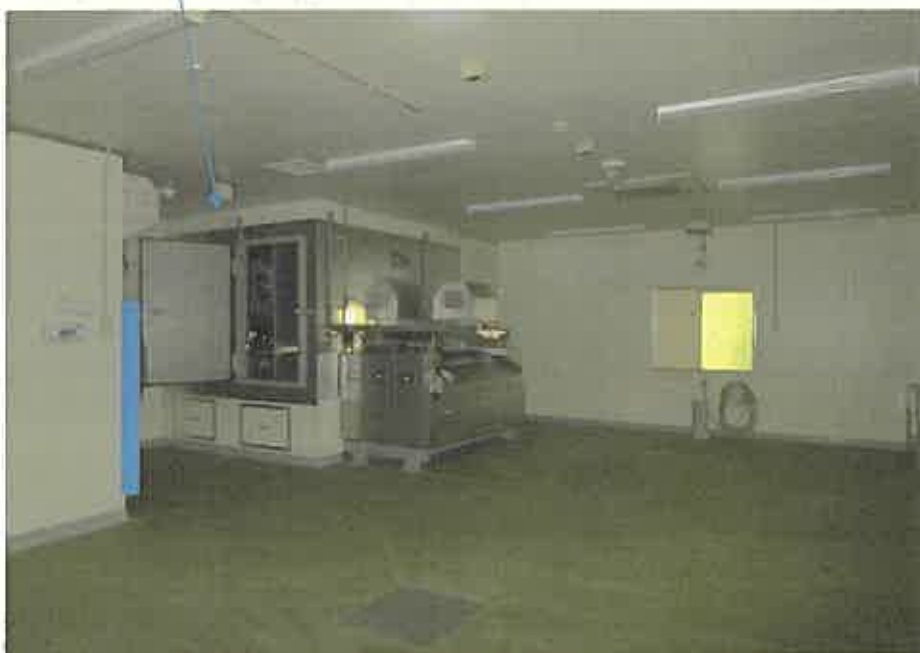
写真⑩ 機械①(トンネルフリーザー)
